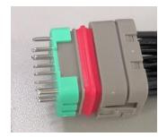
■ 步骤5:将装好端子的接头如图示组装好.
