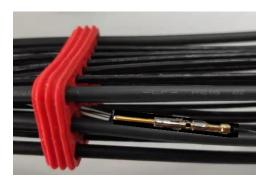
■ 步骤8:用镊子将密封圈装入胶壳,再将外盖扣上胶壳
