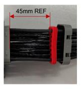
■ 步骤4:将专用工具插进端子插孔里,按下工具顶部的按钮,将端子退出塑料壳,完成连接器拆卸
